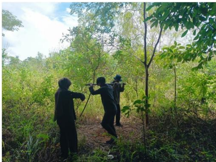
Gambar 3. Pengambilan Sampel Tanah Dengan Hand Boring
