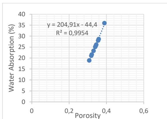
Gambar 2. Hubungan porositas dan water absorption
